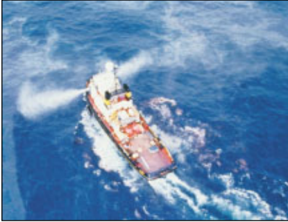
Prueba marítima en Gabón (África Occidental); el dispersante se aplica desde un bote sobre un petróleo crudo liviano, en una proporción de 5–10 por ciento aproximadamente.
